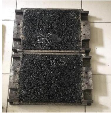
Gambar 3. Benda uji aspal berpori plastik
