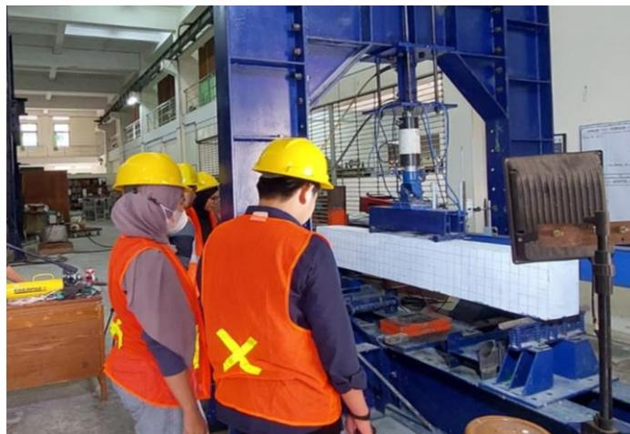
Gambar 7. Realisasi Setup Pengujian Balok
