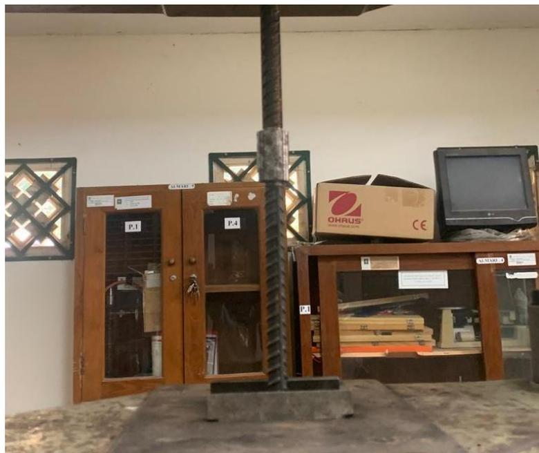
**Gambar 2. Sambungan Baja tulangan menggunakan *Coupler***
