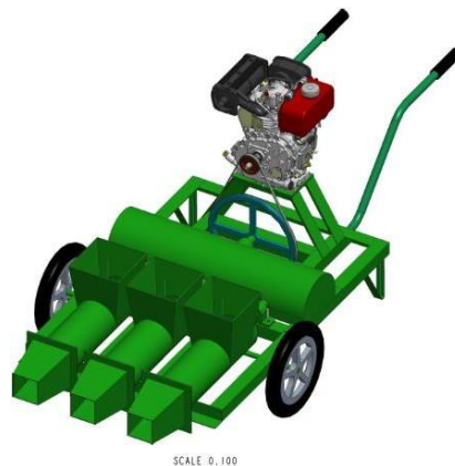
Gambar 4. Rancangan modifikasi alat pengaduk adonan batu bata
