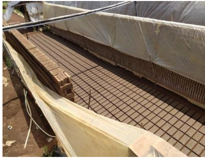
Gambar 3. Proses Penjemuran di atas lahan yang sempit dengan luas 90 \times 88 \times 4 \text{ m}^2
