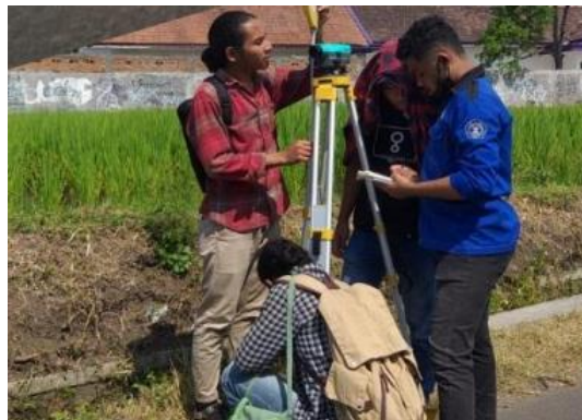
Gambar 3. Survei Topografi pada ruas jalan Telaga Warna
