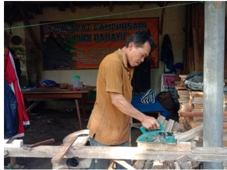
Gambar 1. Proses Penyerutan Kayu untuk dihaluskan menggunakan alat sederhana
