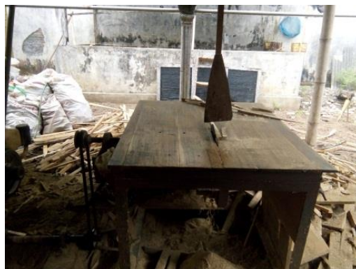
Gambar 2. Proses Pembelahan Kayu menggunakan alat sederhana
