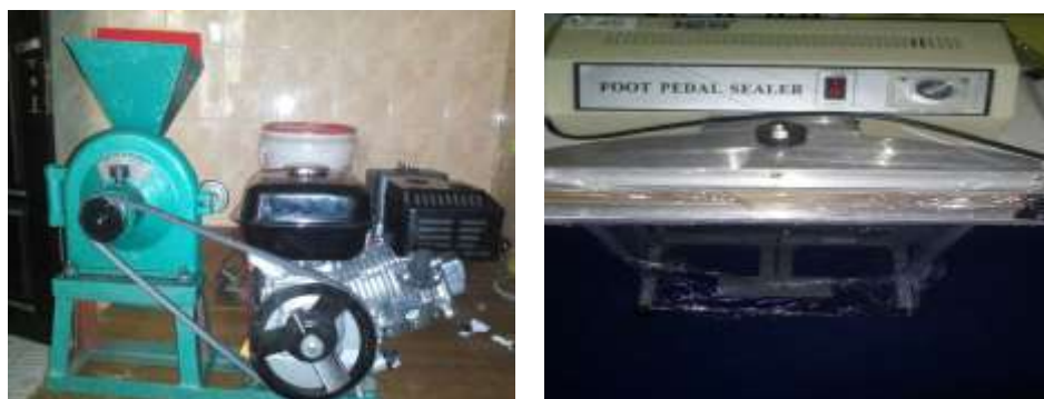
Gambar 8. Dukungan Tim IbM kepada Mitra 2 berupa Mesin penepung tulang type FFC 15 YSK dan foot pedal sealer type FRP 300
